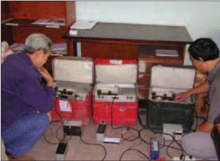
5. De Chinese fysici Chang-chai Hua (links) en Keyun Tang stellen gravimeters af in een kelder in Lusaka, Zambia, voor de eclips van 21 juni 2001.
